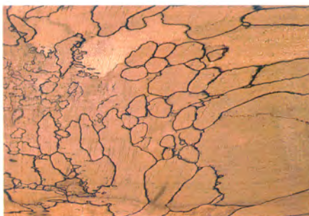
Abbildung 23 Verstockte Buche (beginnende Weissfäule) [D. Grosser 1987]. Bei feuchter Lagerung kann es zur Verstockung von Holz kommen.
