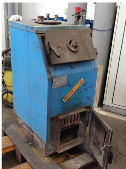
Rys. 4. Widok kotła c.o. typu SKI o mocy 17,5 kW
