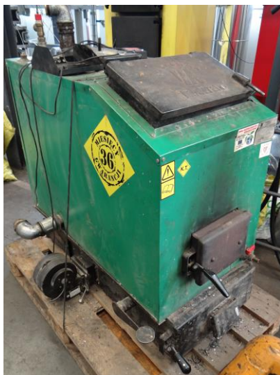
Rys. 3. Widok kotła c.o. typu MODERATOR o mocy 25 kW
